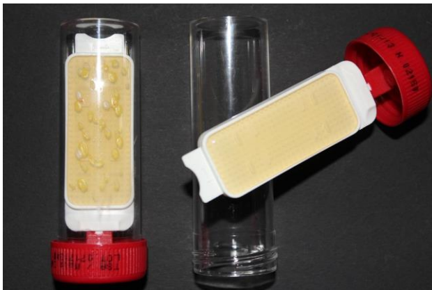
Bild 1: Dip-Slides (rechts vor dem Einsatz unbewachsen, links nach dem Einsatz mit Kolonien bewachsen)
