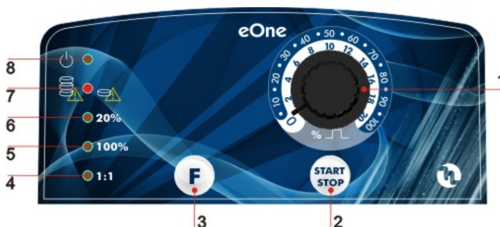
Fig.8 - pannello comandi e segnalazione
